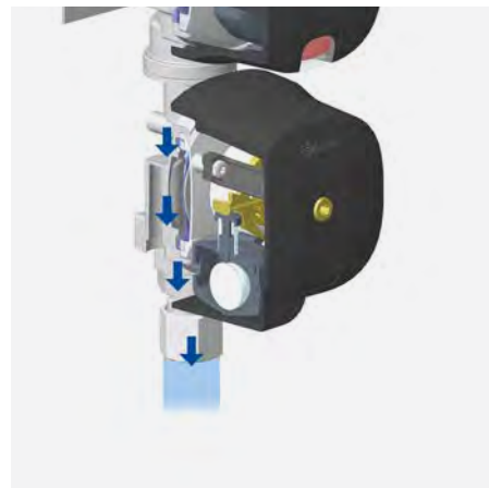
Eftersom crashsensorns kula inte ligger i gasflödet uppstår ingen extra tryckförlust efter gastrycksregulatorn.
